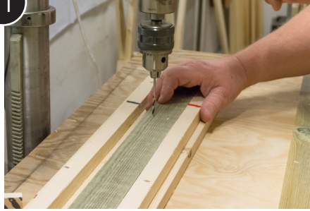
Bore skruenhull i tverrstøtte for støtteben, side 2
