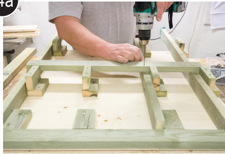
Skrue fast tverrstøtter til ben og støtteben
