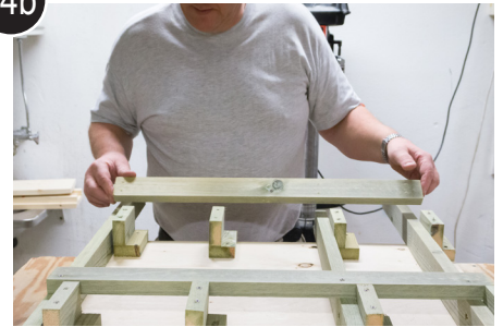
Skrue fast tverrstøtter til ben og støtteben
