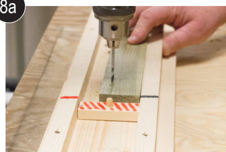
8a Bore skruenhull i alle støtteben, posisjon rødt
