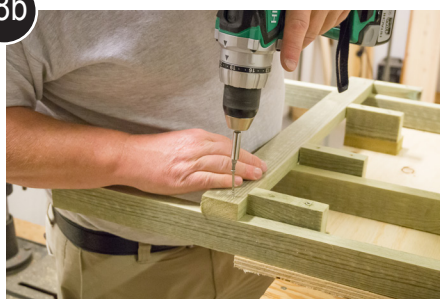
Skrue fast tverrstøtter til ben og støtteben
