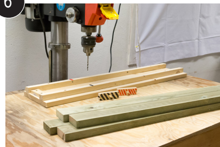
6 Forboringsjigg og støtteben
