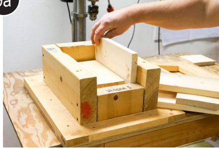
Legg sidevegger og bunn i monteringsjigg for frontvegg
