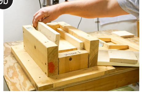
Legg sidevegger og bunn i monteringsjigg for frontvegg
