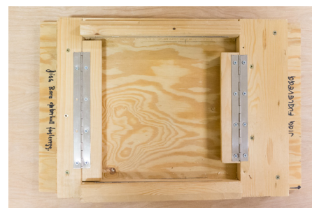
Borejigg skruer hull front – og bakvegg
