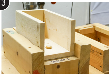
Sett fuglehullvegg på tapp
