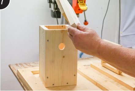
Sett taket på fuglekassa
